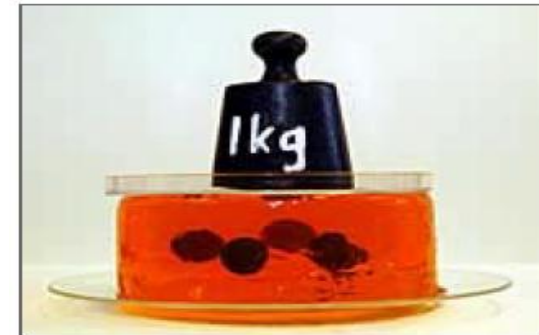
FIGUR 1: En hydrogel som består av 96 prosent vann og fire prosent polymer. Hydrogelen er tilsatt noe fargestoff. Merk lasten som hydrogelen bærer; økes belastningen ytterligere, vil gelen deformeres kraftig, men den går tilbake til sin opprinnelige form når lasten fjernes. I hydrogelen er det også innstøpt fargete plastkuler for å illustrere at gelen kan være fysisk bærer av andre stoffer. Foto: Ståle Skogstad (©)
