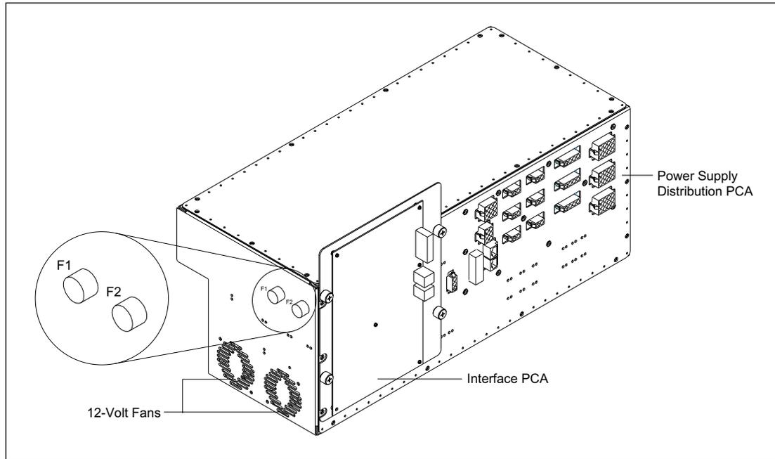
Figure 5-10. Power Supply Box (CE 2001).
