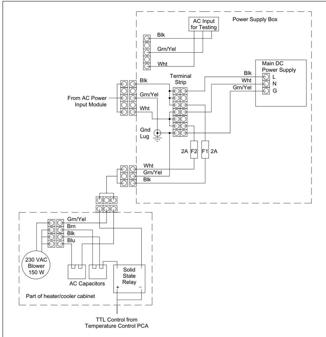
Figure 5-4. Main AC Distribution Block Diagram (CE 2001).
